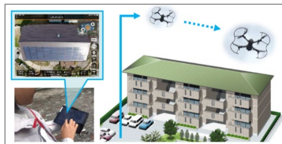
ドローンによる屋根点検技術 (画像提供：大和ハウス工業)
