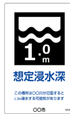
図 6.3.3 浸水標識の一例（1.0m）
