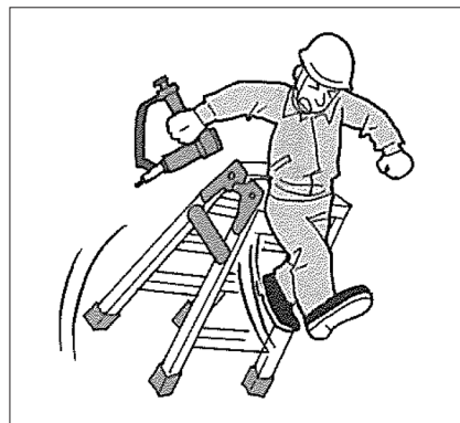
脚立から下りる際に踏板を踏み外して墜落する危険
