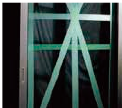
2kg相当の飛来物を衝突速度44km/hでフロートガラスに衝突させた検証実験 写真提供：(一社)板硝子協会
