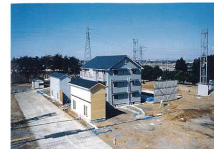
実大規模の木造3階建共同住宅での火災実験
