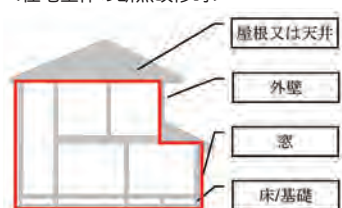
＜住宅全体の断熱改修時＞
